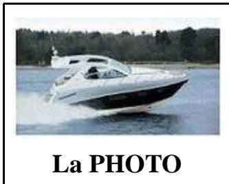
Une coque qui flotte et qui se déplace sur l'eau grâce à une hélice entraînée par un moteur à essence et dirigée par un gouvernail.
