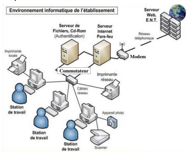
On distingue deux types de réseaux : les réseaux locaux et les réseaux étendus. Dans un réseau local, les ordinateurs sont répartis dans une même salle, un même bâtiment, un même établissement. Dans un réseau étendu, les ordinateurs sont répartis dans de grands espaces géographiques. Le plus grand réseau étendu étant l'Internet.
