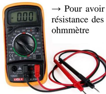
→ Pour avoir un information chiffrée de la résistance des matériaux, on peut utiliser un ohmmètre
